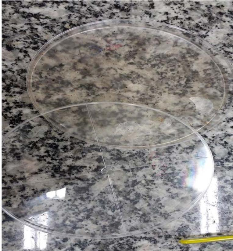
Figura 1. Amostra do biopolímero padrão, sem a incorporação do resíduo, na placa de Petri.
